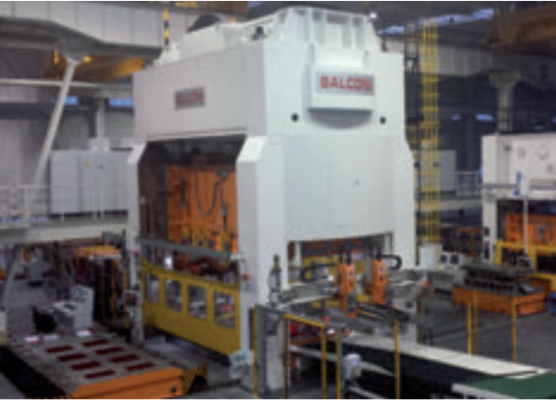
La pressa 4DMRF-LD da 1600 ton della Balconi Pressecentriche installata presso lo stabilimento di Guangzhou della Snop Automotive Parts.
